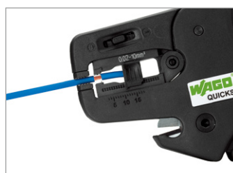
電線のむき出し
