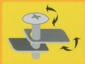
■ 接続不良による発熱
